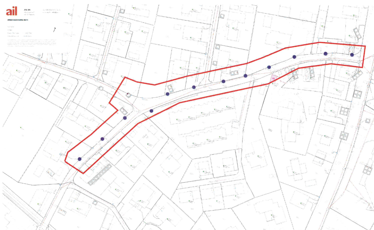
Visualizzazione dei punti luce (punti viola) dopo il potenziamento dell'illuminazione pubblica (fonte AIL SA)
