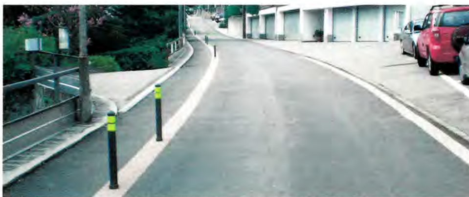
Figura 6: Esempio di sistemazione stradale con fascia pedonale
